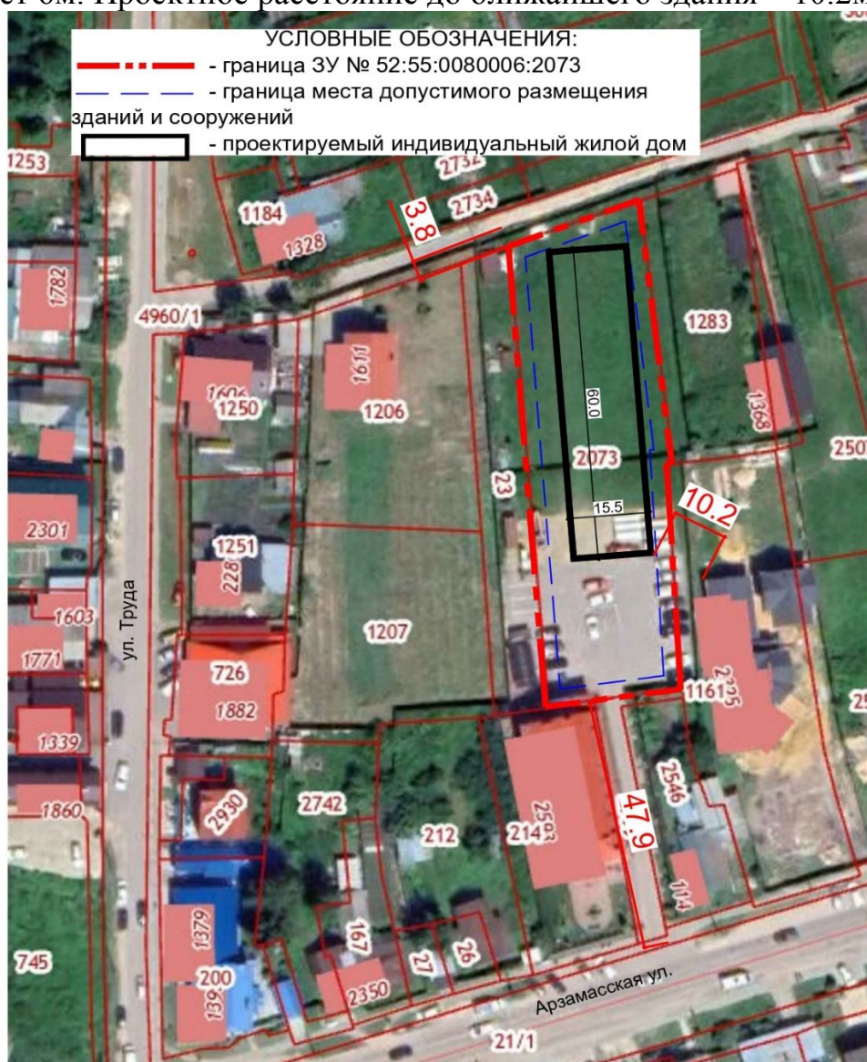
Рис.2 - Схема расположения подъездов пожарной техники и минимального противопожарного расстояния.
